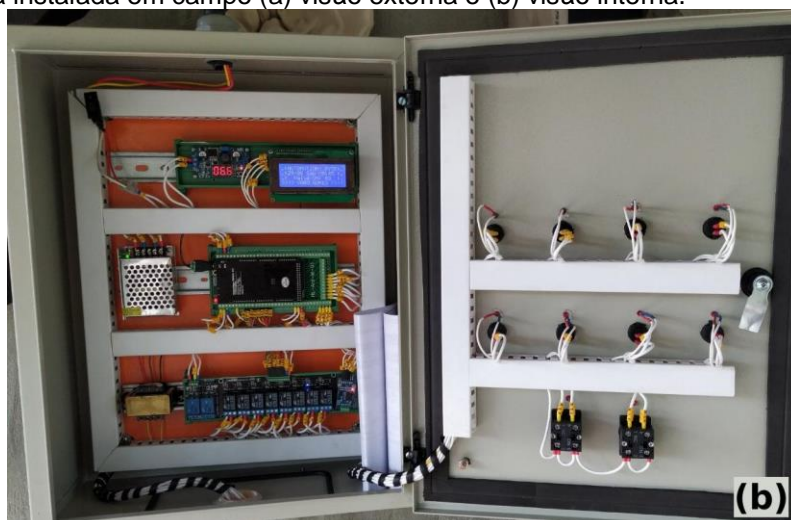
Figura 8 - Caixa de comanda instalada em campo (a) visão externa e (b) visão interna.
