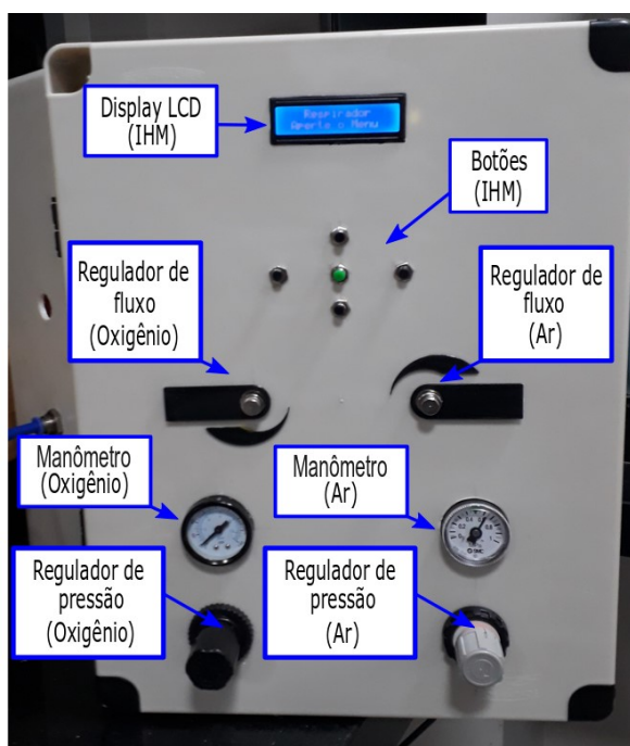
Figura 4 – Vista frontal do protótipo do ventilador pulmonar InovAr VP1.
