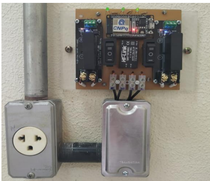
Figura 4 – Protótipo utilizando relé de estado sólido.
