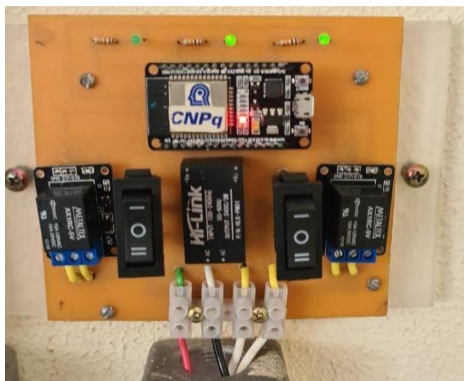
Figura 3 – Modelo do protótipo utilizando relé de eletromecânico.
