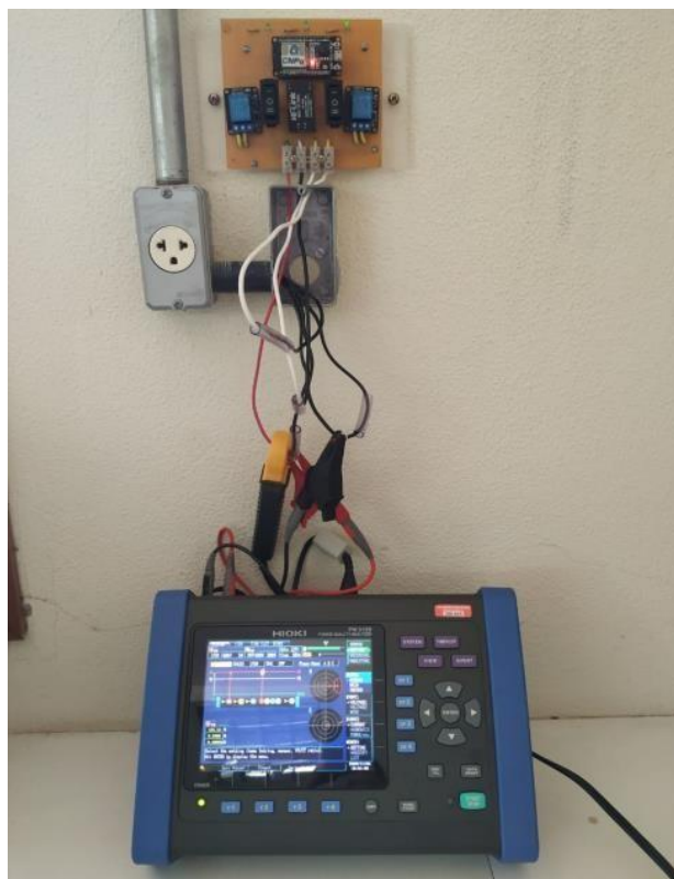
Figura 8 – Medições com o analisador de qualidade de energia elétrica.
