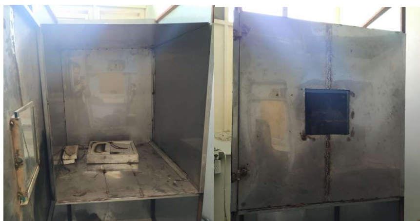
Figura 2 - Câmara de aquecimento para a fabricação de lacas solares de filmes finos.
