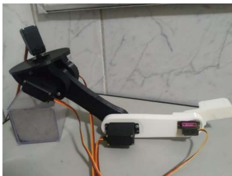
Figura 7 - Braço mecânico fabricado até o momento.
