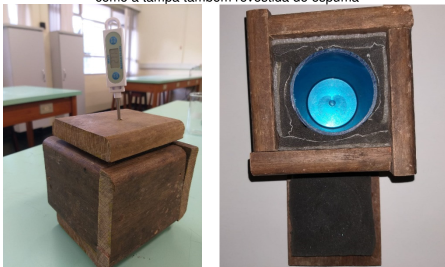
Figura 1 – Montagem do calorímetro realizado pelo Grupo A. É possível observar a estrutura interna para a contenção dos líquidos utilizados, assim como a tampa também revestida de espuma
