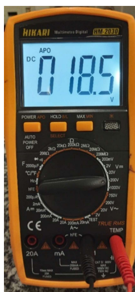
Figura 11 - Medição da tensão CC na carga utilizando o capacitor de 100\ \mu\text{F} na filtragem.
