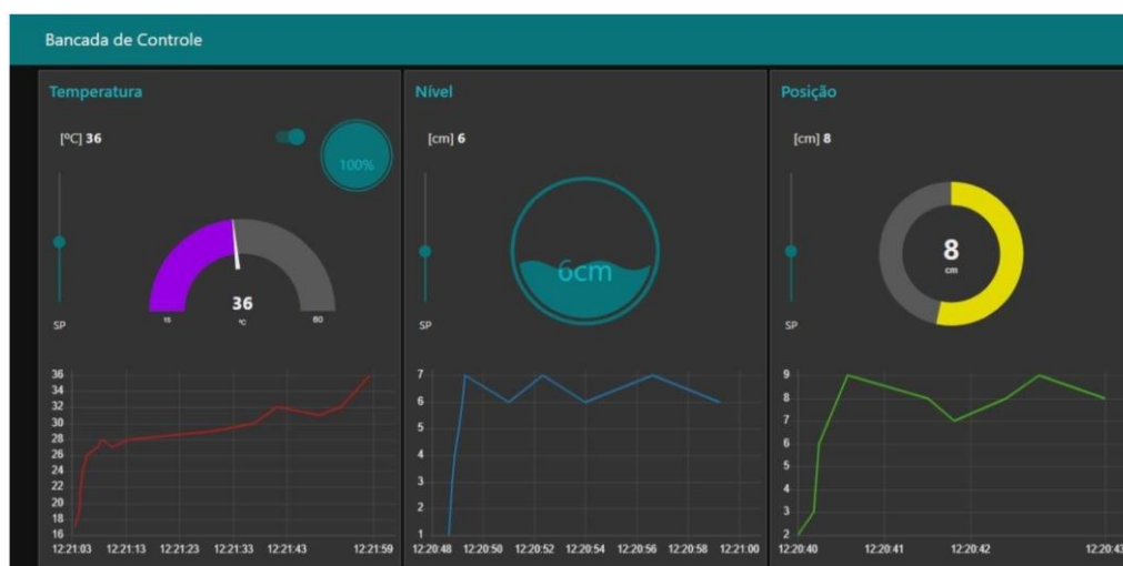
Figura 7 – Interface Homem Máquina da bancada didática.
