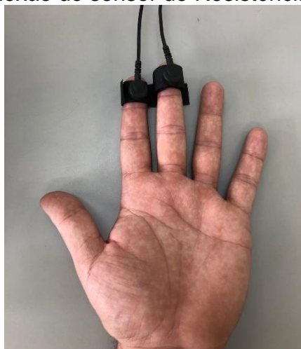
Figura 1 – Conexão do sensor de Resistência Eletrodérmica
