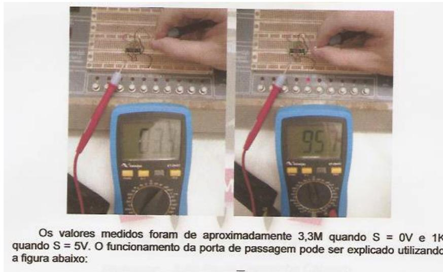
Figura 12: Resultado obtido com a porta de passagem implementada com o CD4007.
