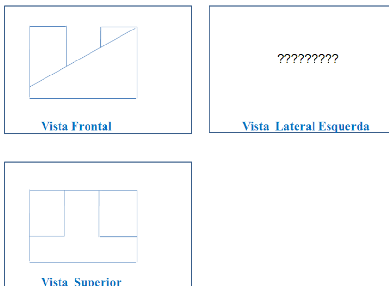
Figura 3 – Exemplo de Exercício Desenvolvido Passo-a-Passo para Determinação da Vista Lateral Esquerda
