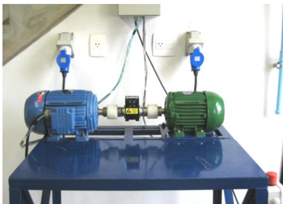
Figura 11. Detalhe da Bancada do dinamômetro.
