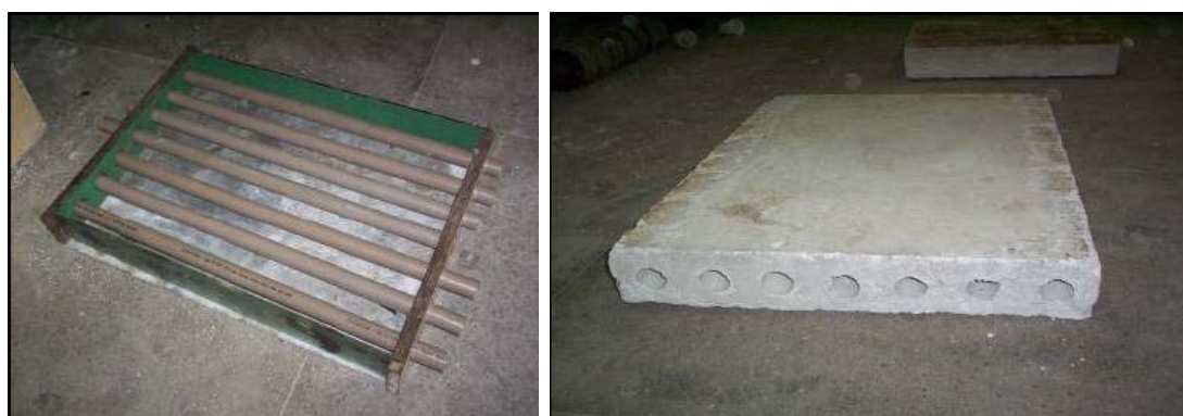
Figura 2 – Molde e painel pronto. Fonte: Souza et al., 2006
