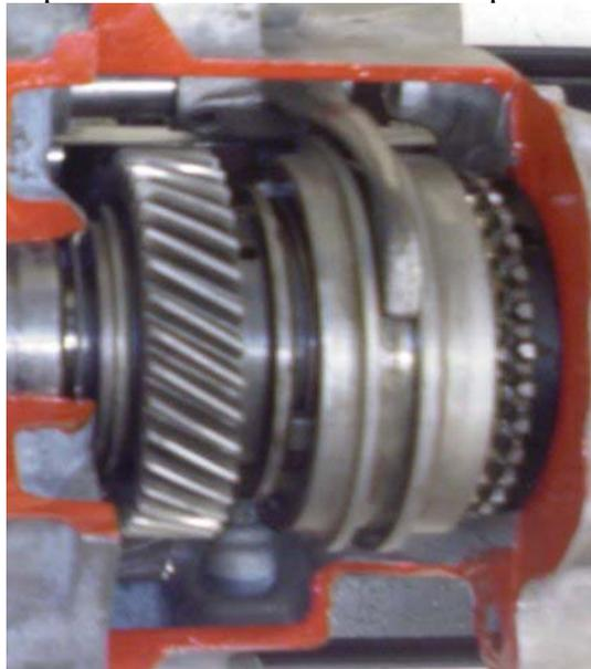
Figura 8: Primeiro corte da tampa seletora.
