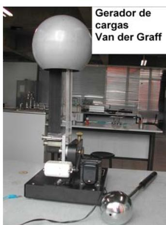
Figura 3 – Fotografia do Gerador de cargas Van der Graff
