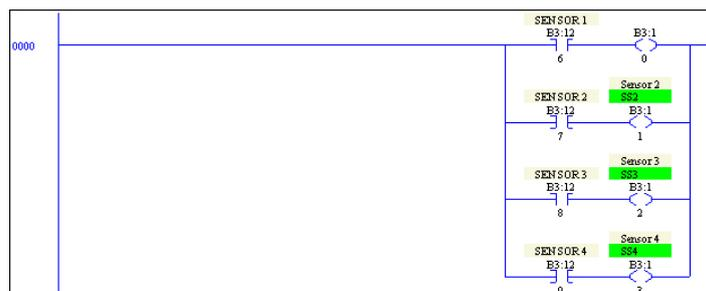
Figura 8. Diagrama Ladder da subrotina *INPUT* do sistema de manufatura com duas esteiras e quatro sensores fotoelétricos.
