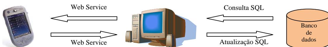
Figura 2 - Estrutura básica do sistema.
