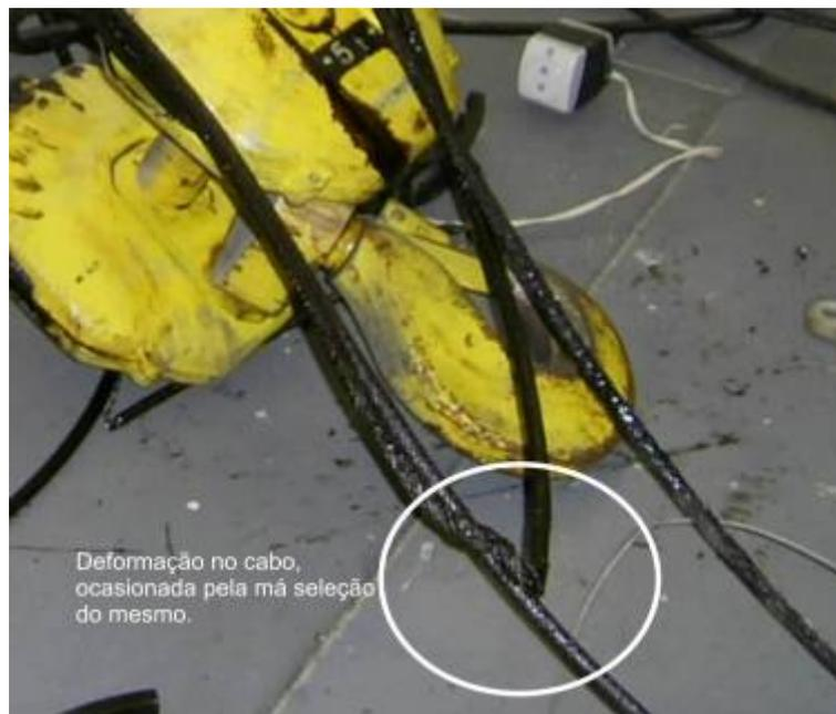
**Figura 3.** Corte no cabo para elevação de cargas, ocasionada pela má seleção do mesmo.
