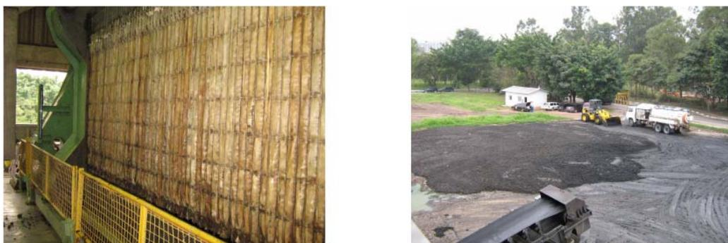
Figura 7 – Dois métodos de secagem de lodo: Esq: Filtros-prensa (secagem e adensamento). Dir: Pátio para espera para transporte do lodo.
