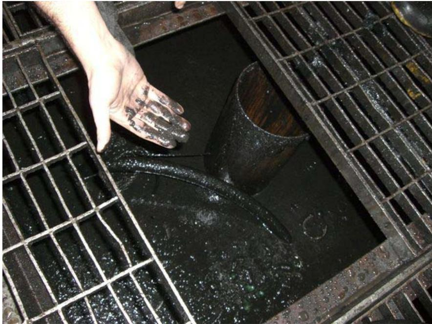
Figura 6 – Efluente da lavagem de peças
