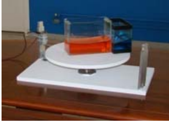
Figura 10 – Componente da força centrípeta atuando nos líquido
