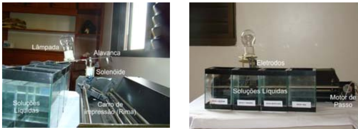
Figura 6 – Estrutura mecânica do experimento Correntes Elétricas em Soluções líquidas
