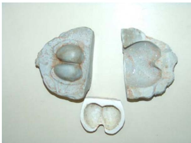
Figura 2 Modelo e molde para conchas Pelton
