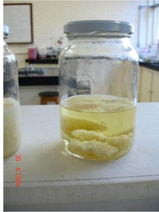
Figura 8 - Reação de transesterificação que não deu certo (saponificou) devido à presença de umidade na reação. O sabão é mais denso e afunda no óleo remanescente.
