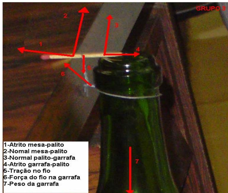
Figura 4 – Estrutura com os esforços representados.
