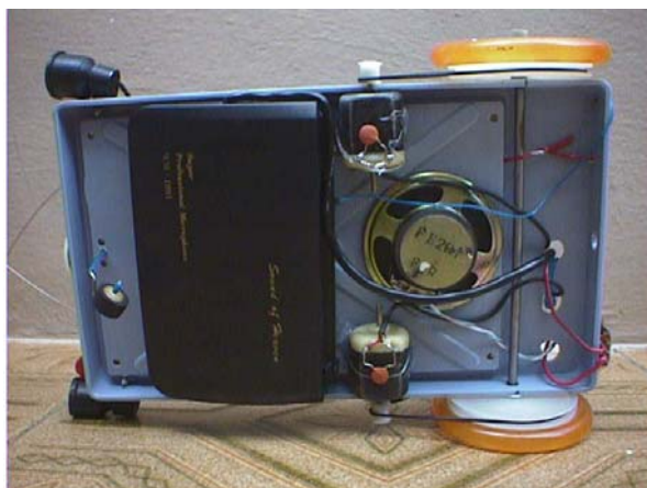
Figura 3 – Receptor do Head-Fone utilizado no carrinho para enviar os comando de voz no microprocessador Sensory.
