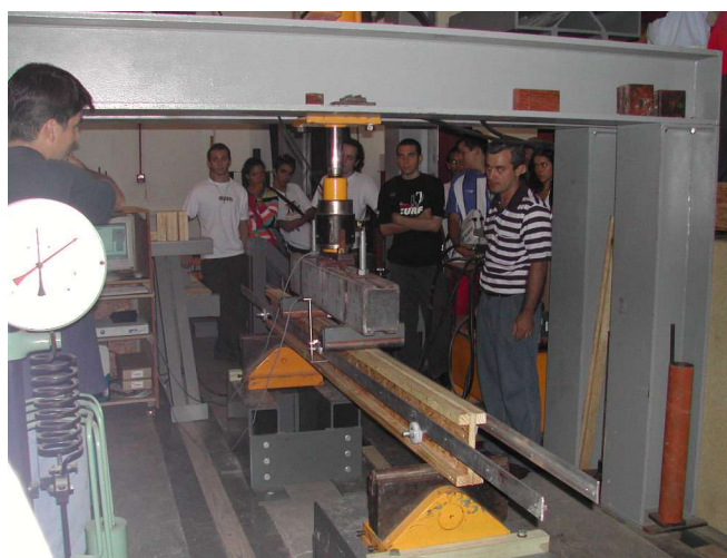
Figura 7 -Ensaio de Flexão em viga de madeira.
