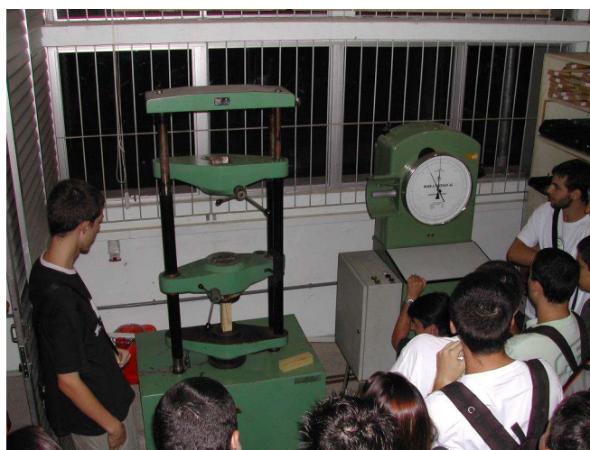
Figura 6 - Ensaio de Compressão Axial da madeira.
