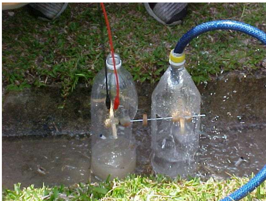
Figura 2 – Montagem de uma usina hidrelétrica
