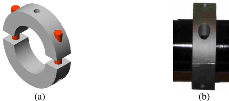
Figura 10 – (a) Desenho do dispositivo de fixação do sensor a parede; (b) Foto do dispositivo.
