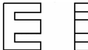
Figura 1: Núcleo Tipo "E"
