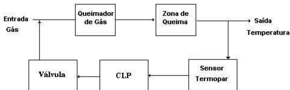
Figura 4 – Diagrama de blocos do sistema de controle
