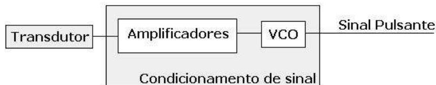
Figura 5 – Diagrama em blocos do Condicionamento de Sinal
