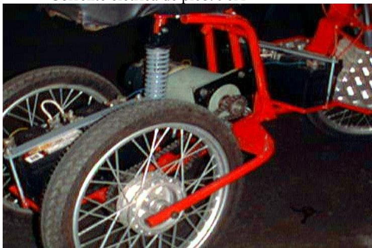
Foto 3: Mostra o motor e sistema de acionamento.
