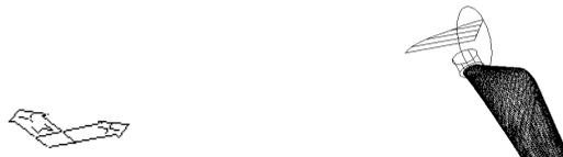
Digita-se `3darray`, `all`, `p`, `3`, `angle to fill 360`, `y`, `center point of array` → centro da circunferência da base da parábola 3D, `second point on axis of rotation` → extremo da altura da parábola 3D. O desenho aparece como a seguir:
