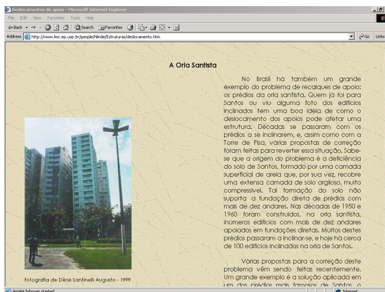
Figura 4: Deslocamentos de apoio: recalque de apoio na orla santista (endereço: http://www.lmc.ep.usp.br/people/hlinde/estruturas/deslocamento.htm )
