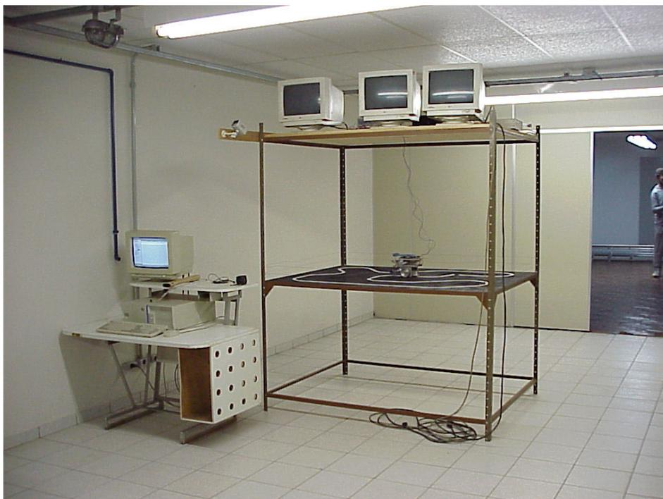
O ambiente ilustrado na Figura 14 ilustra onde foi desenvolvido o desafio “Andando na Linha”. No microcomputador os alunos dispunham dos softwares de desenvolvimento de programação assembly e do software de gravação do conteúdo de memória no microcontrolador da Atmel. No dia da apresentação final, só era permitido a gravação do microcontrolador, modificações do Software não eram permitidas.
