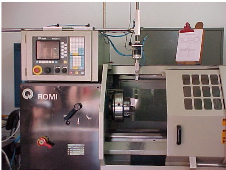
Figura 3- Manipulador Integrado a um Torno CNC
