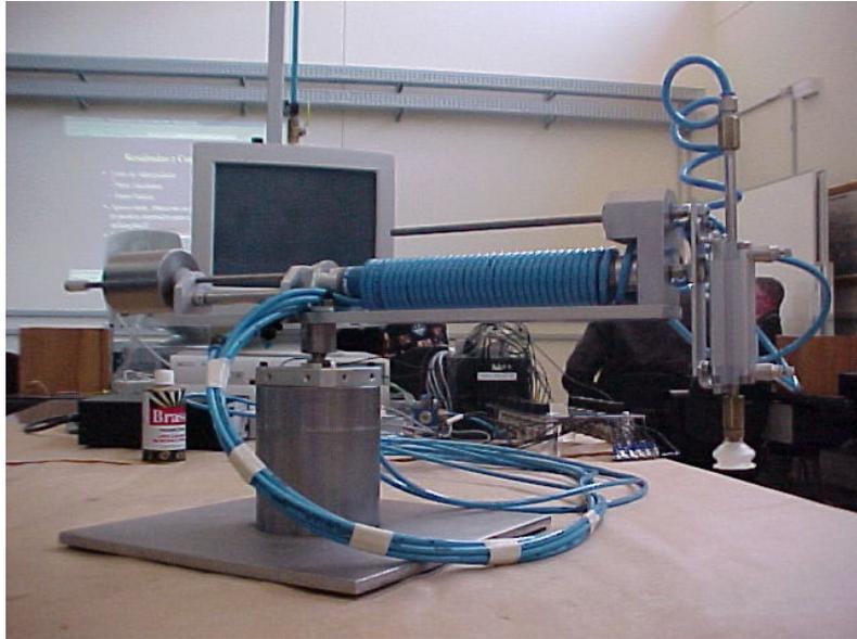
Figura 2- Protótipo de Manipulador para Movimentar Peças
