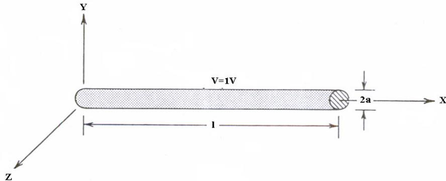
Figura 1 - Fio reto linear finito com diâmetro desprezível
