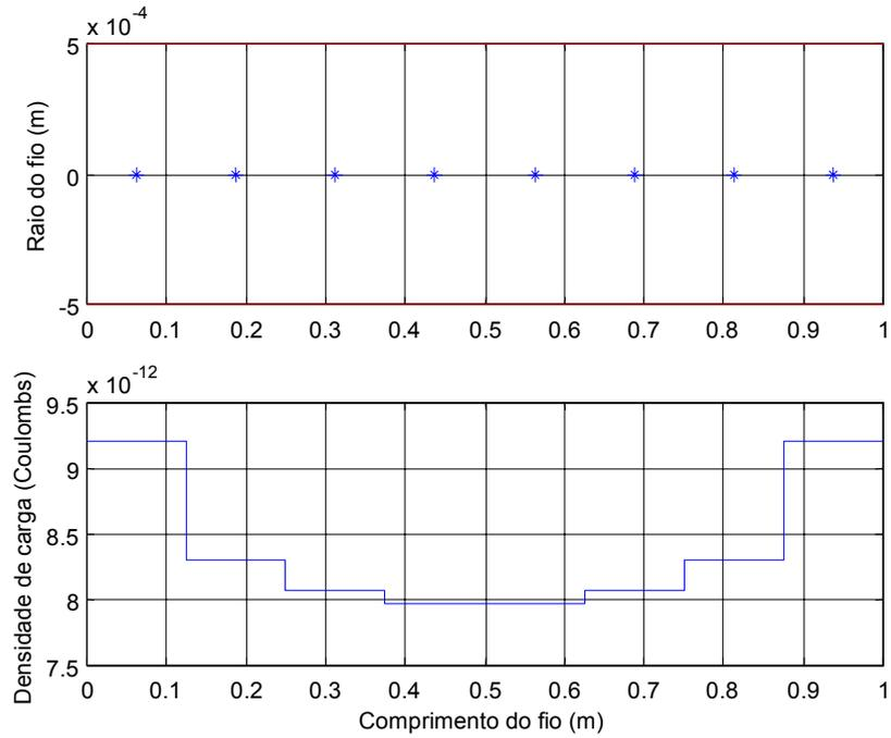
Figura 3 - Distribuição de carga de um fio reto dividido em 8 segmentos iguais
