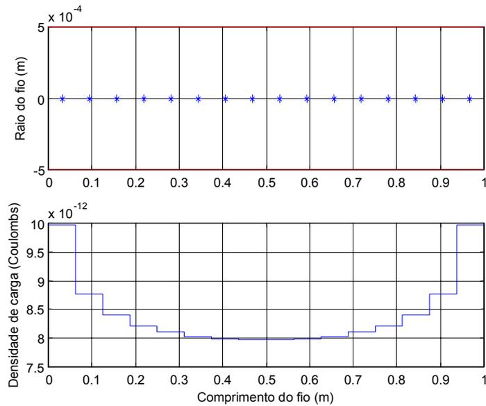
Figura 4 - Distribuição de carga de um fio reto dividido em 16 segmentos iguais
