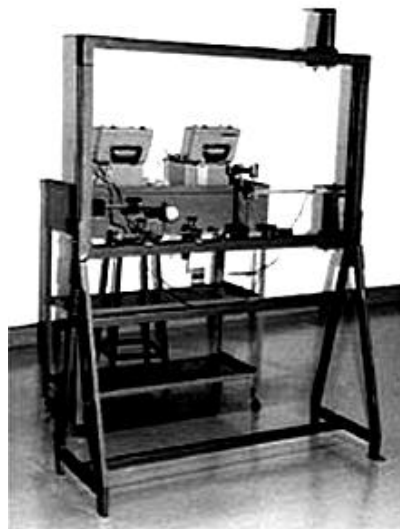
Figura 2 - Quadro-suporte, mostrando uma viga em balanço sendo ensaiada.
