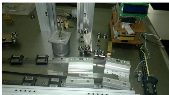
Figura 5 – Carro/roldana que desloca os potenciômetros do protótipo.
