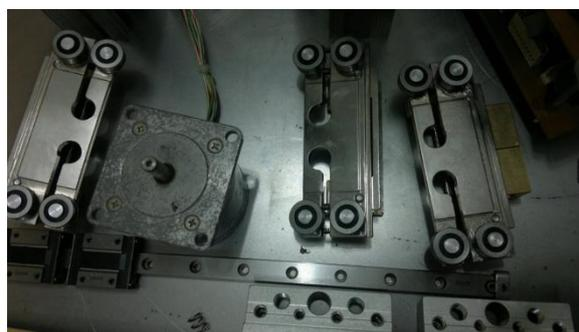
Figura 3 – Réguas verticais (à esquerda) e carros/roldanas (à direita) do protótipo.
