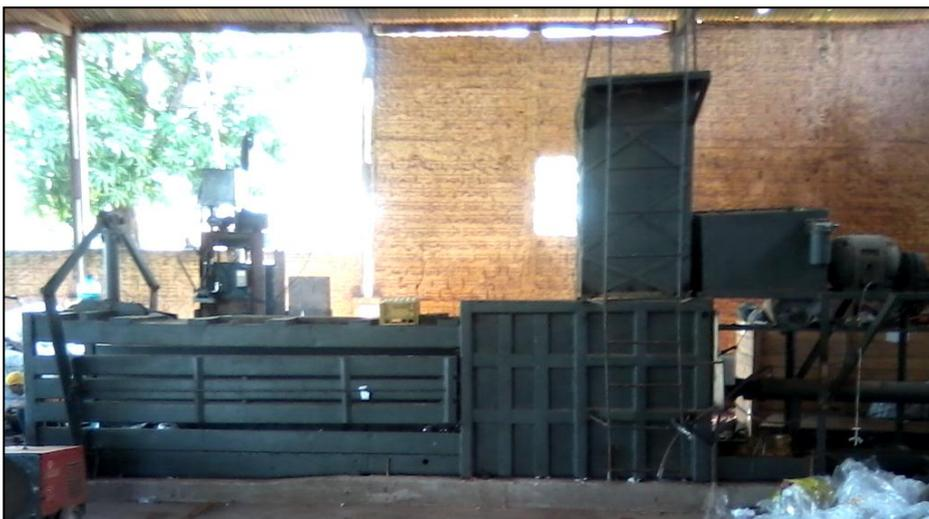
Figura 1b - Prensa horizontal contínua.
