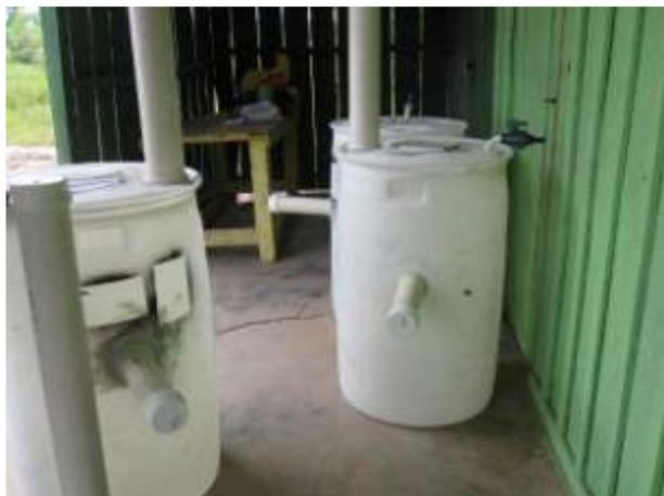
Figura 03: Biodigestor caseiro.
