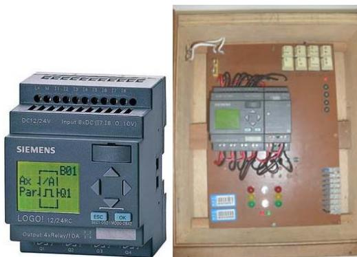
Figura 6 - Fotografia do módulo do CLP utilizado e o kit didático
