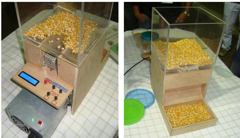
Figuras 1 e 2: Protótipo finalizado simulando a alimentação de aves.
