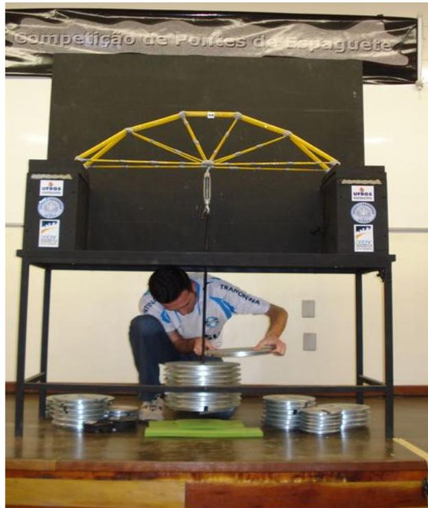
Figura 3 – Ponte de espaguete submetida à carga de ruptura na bancada da UFRGS.
