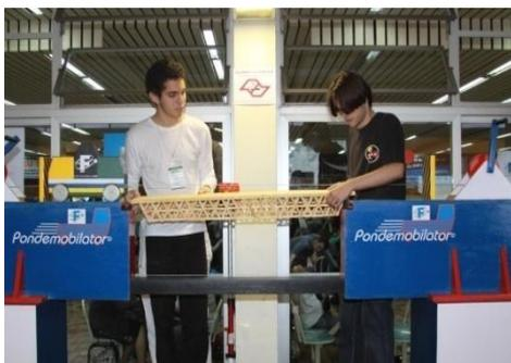
Figura 7 – Alunos posicionando sua ponte de palitos no equipamento para ensaio com carga móvel no concurso Travessia FEI.
