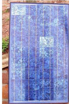
Figura 3: Painel solar de silício policristalino instalado no Colégio Politécnico - UFSM.
