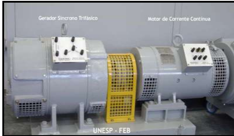
Figura 01 – Sistema real existente em laboratório composto por uma máquina síncrona e uma máquina de corrente contínua.
