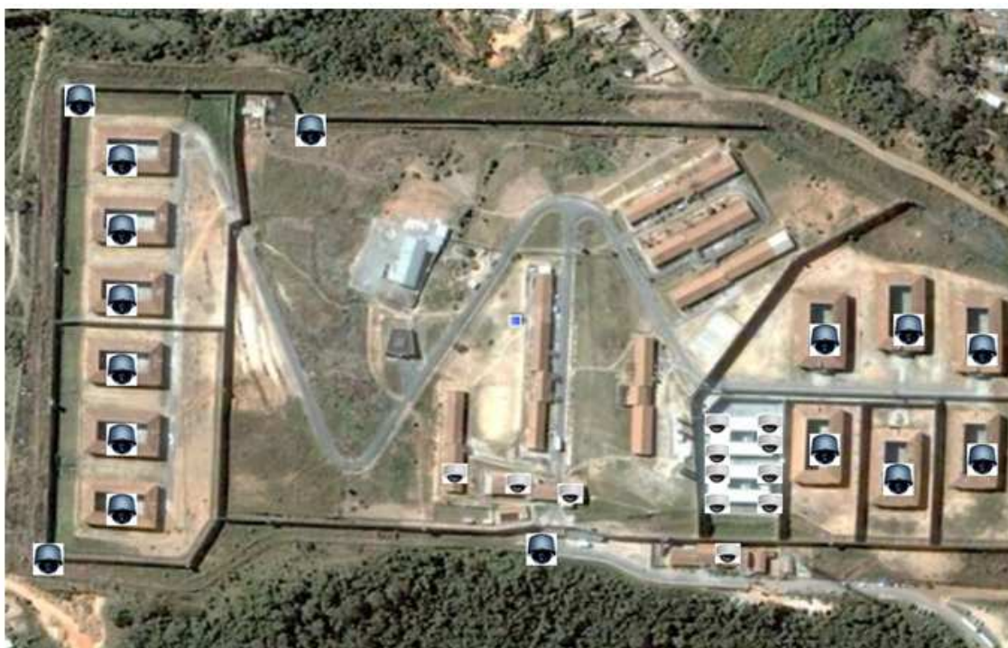
Fig. 1 – Modelo de Distribuição de Câmeras em uma Unidade Prisional
