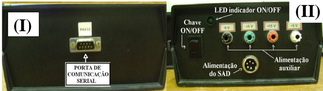
Figura 2 – (I) Vista da parte traseira e (II) Fonte de Alimentação do SAD
