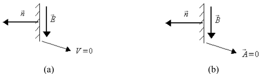
Figura 3 - Ilustração de um caso de aplicação da condição de contorno de Dirichlet, para (a) um problema de eletrostática e (b) um problema de magnetostática.
