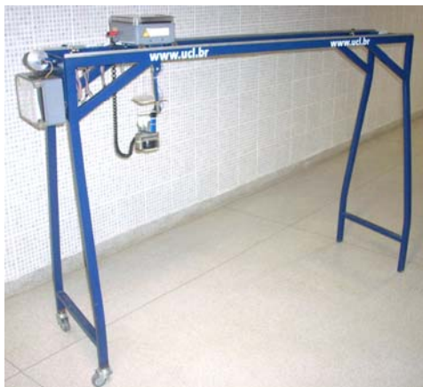
Figura 1. Equipamento didático que simula uma ponte rolante, desenvolvido pela equipe da UCL.
