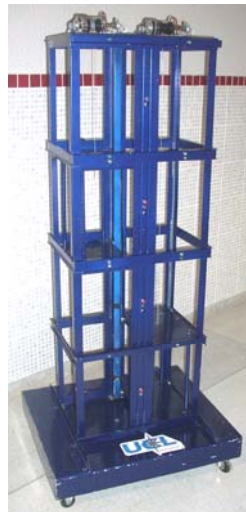
Figura 2. Equipamento didático que simula um conjunto de dois elevadores com quatro andares, desenvolvido pela equipe da UCL.
